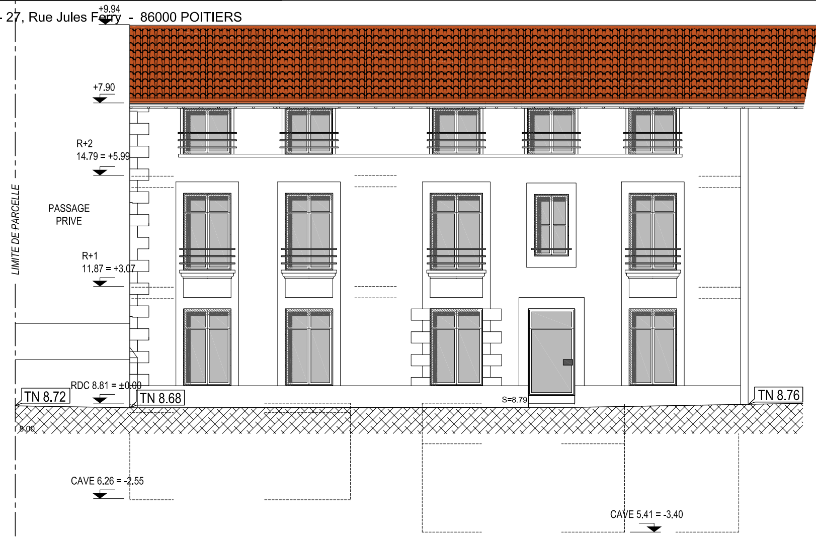
FACADE NORD-OUEST Rue Jules Ferry
